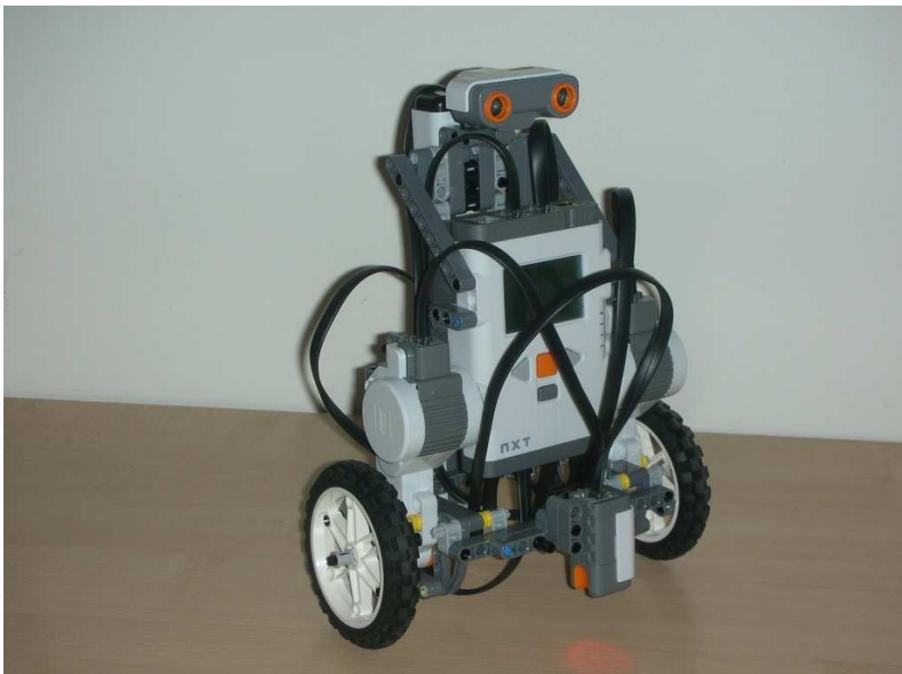
*Figura 3.4: Legway dotato di due sensori di luce, un sensore ad ultrasuoni e un giroscopio*
