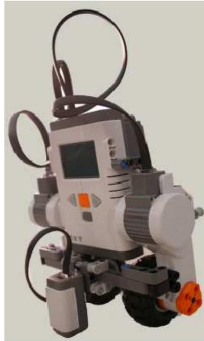
*Figura 3.1: segway; legway con un sensore di luce*
