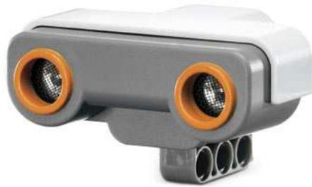
*Figura 2.6: Sensore ad ultrasuoni*
